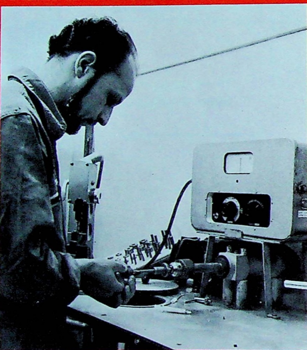
5. Dans cet atelier climatisé (20 à 23°C), sont préparés les « étalons » qui servent au contrôle des pièces qui auront à coulisser entre elles (exemple : chemises et tiroirs). L'outilleur rède son étalon avec de la poussière de diamant. Sur l'écran de l'appareil de mesure, une graduation représente 1/10 de micron.
