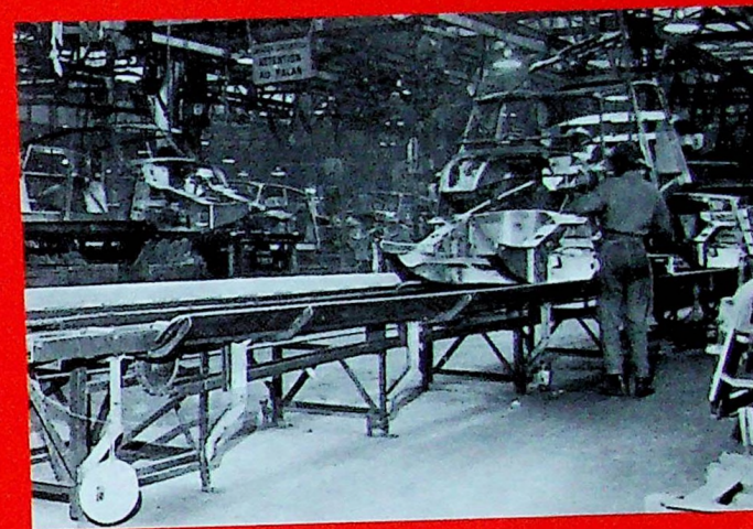
2. Sur cette soudeuse multipoints capable de 200 points de soudure, effectués en deux temps, passe le caisson complet.
