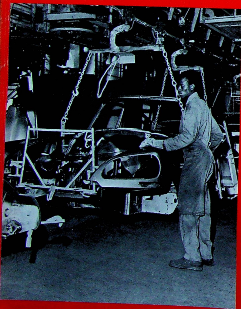
4. Accrochage des éléments de la robe, sur la caisse : la carrosserie est prête pour les opérations de peinture
