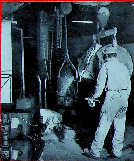
Venant des fours électriques, la fonte en fusion est amenée par un monorail dans des poches-tonneaux, appelées « Marie-Jeanne ». De là, elle est versée dans la poche de coulée qui circule autour du convoyeur sur lequel sont placés les moules.
