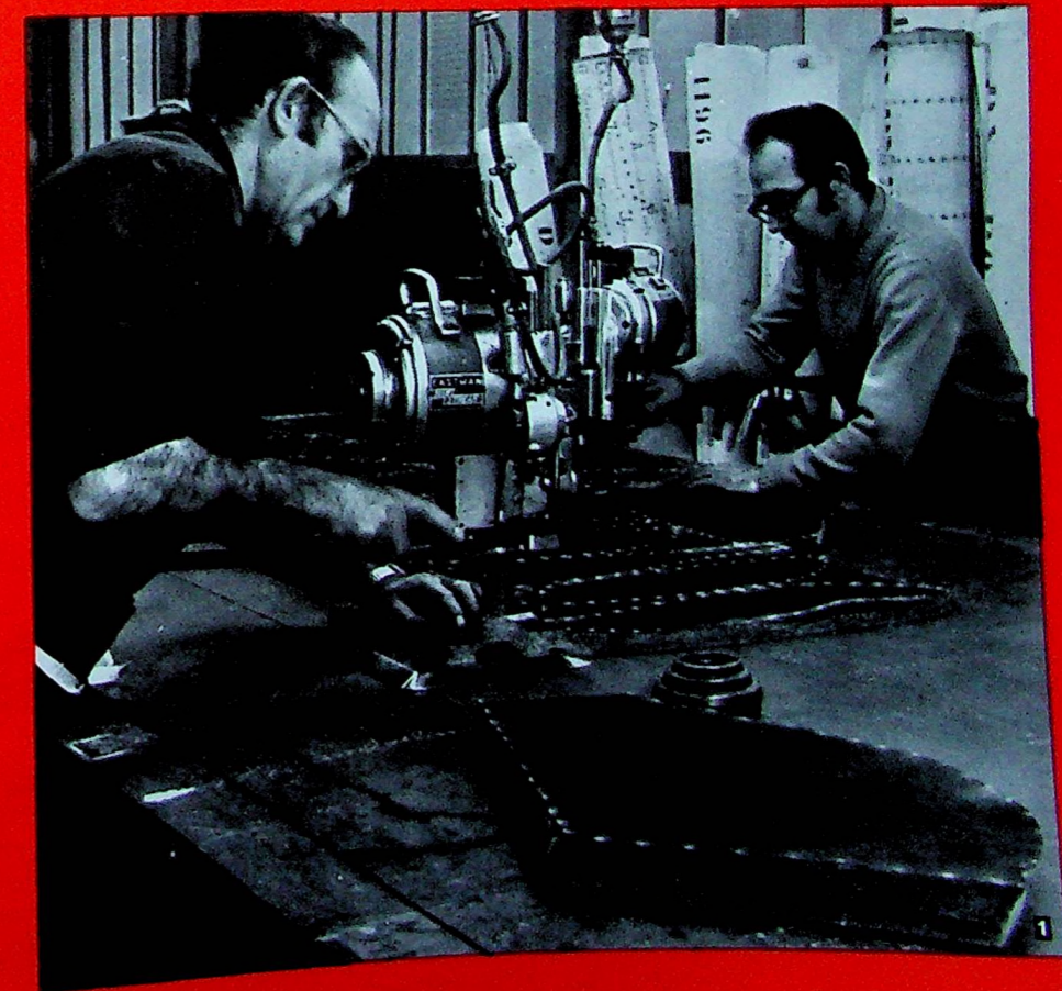
1. La découpe d'un « matelas » : ici vingt-cinq épaisseurs de targa destinée aux garnitures. Le tracé des pièces apparaît en blanc. (Talc passé à travers les perforations des patrons de découpe.)
