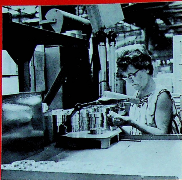
4. En fin d'usinage, le contrôle : la pièce doit être précise, au 1/100 de millimètre, près. Entre le palier et le corps de pompe, l'étanchéité doit être parfaite. Placés dans des paniers conçus spécialement pour les recevoir, les corps de pompe gagnent le secteur de montage où ils rejoignent les autres éléments composant la pompe.
