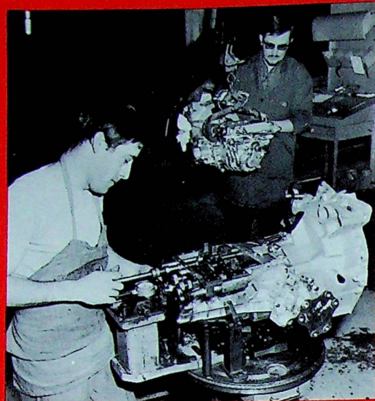
8. Le réglage d'une boîte de vitesses à commande hydraulique. Derrière, un contrôleur examine attentivement l'aspect de la boîte et l'individualise en lui apposant une médaille.
