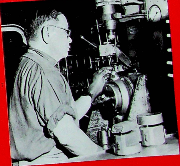
4. Après un coup de pinceau, destiné à repérer les surfaces de contact pour le réglage du pignon sur la couronne, le compagnon inscrit la cote de réglage des deux pièces sur le pignon, les deux pièces ne se quitteront plus. 5. Mise en place du croisillon dans la mâchoire à plateau, avant injection de nylon. 6. Assemblage de l'arbre de transmission et de la mâchoire double. L'opération demande un véritable coup de main. 7. Pose des rotules dans les pivots.
