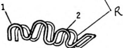
5. Accrocher la boucle 1 du ressort R sur le rivet de la plaquette et la boucle 2 sur l'axe inférieur de maintien des plaquettes.
