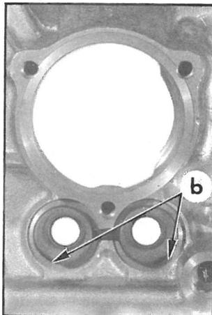
Depuis Décembre 1972, les joints des tubes-enveloppes sont sans talon de centrage dans le carter et leur positionnement est différent suivant le type de moteur (voir photos ci-contre). Le montage de ce type de joint n'est pas possible sur les moteurs sortis avant cette date.
