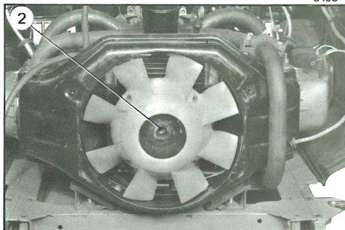
7. Mettre en place la tôle d'étanchéité arrière (1) du collecteur d'air ( s'il y a lieu ).
