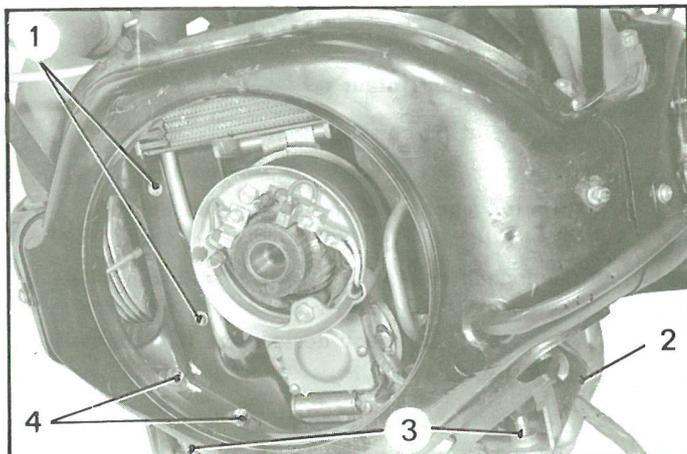
11. Présenter les blocs élastiques sur le collecteur d'air et visser les écrous (4) de quelques filets.
