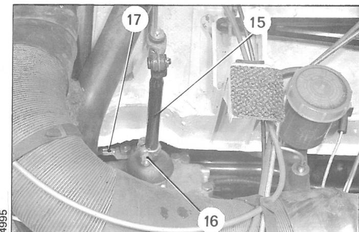
**28. Accoupler la durite d'alimentation de la pompe à essence à la canalisation sur longeron gauche.****29. Accoupler le levier de liaison au levier de commande des fourchettes :**
