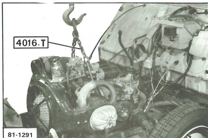
**10. Défreiner et déposer** les vis de fixation des supports élastiques avant du moteur.
