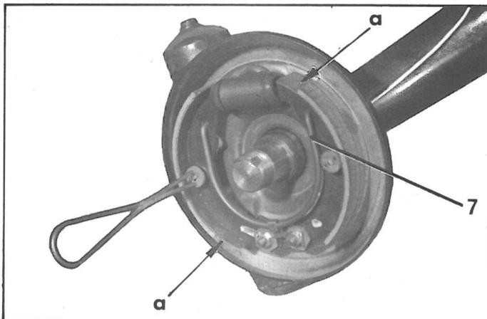
NOTA : Pour conserver une bonne répartition du freinage, il faut toujours remplacer les quatre segments à la fois. De plus, il est souhaitable que les tambours aient le même état de surface.
