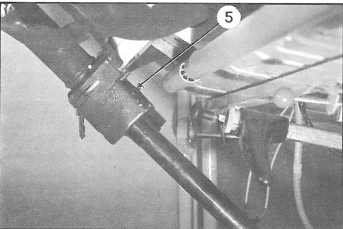
21. Poser, ( *suivant le cas* ) le tube de liaison, entre le pot de détente et le silencieux.
