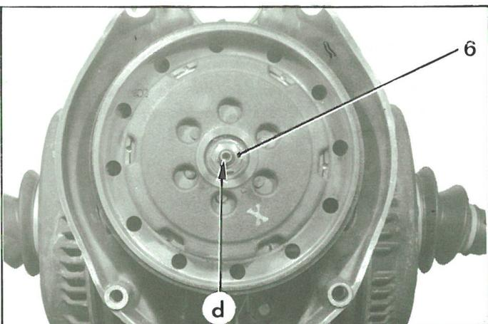
7. Si nécessaire, rectifier la portée du disque sur le volant moteur, ( mandrin MR. 630-35/9 ).
