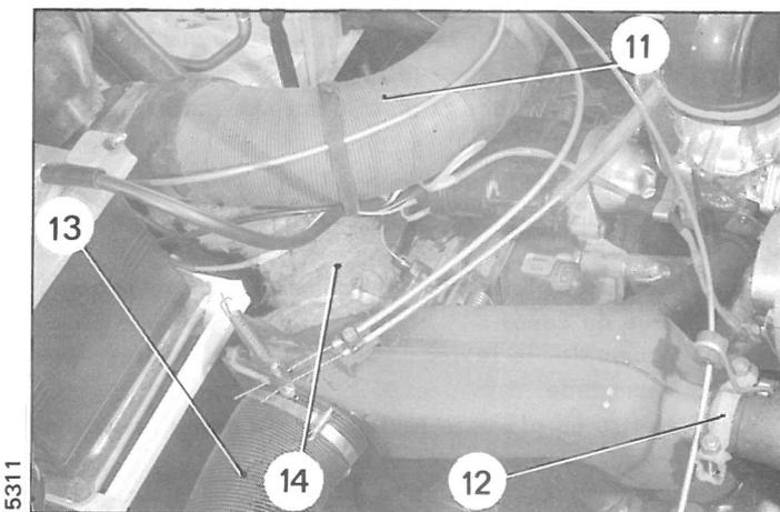
**27. Monter les échangeurs de chauffage (si nécessaire) :**
