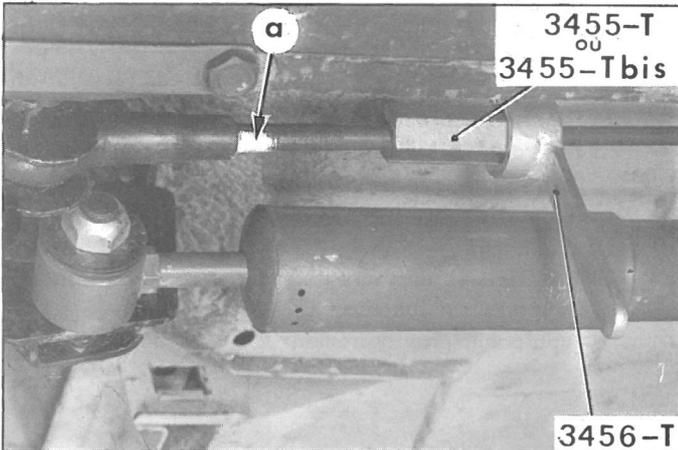
2. Déposer l'amortisseur arrière ( et, suivant le cas, l'amortisseur avant ).
