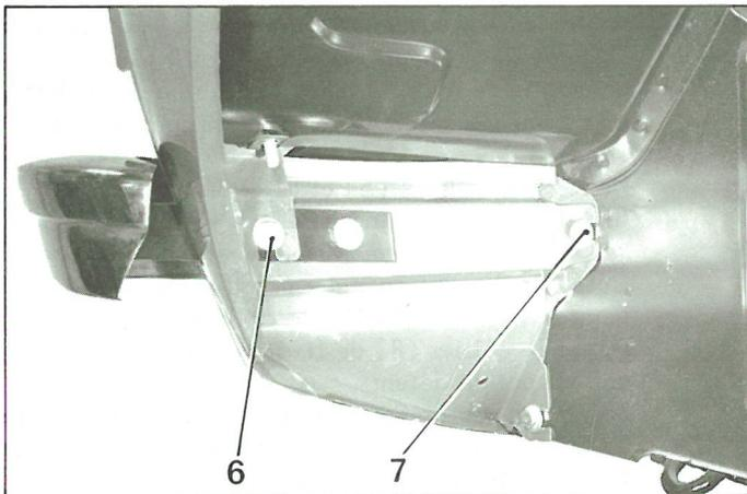
35. Accoupler le flexible de commande de déverrouillage du capot :
