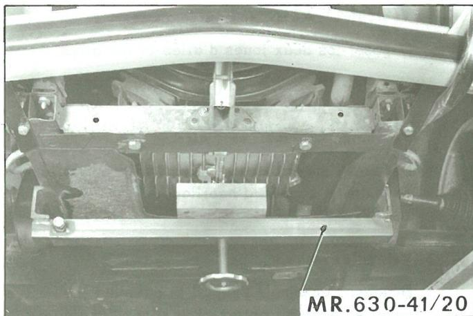
9. Soulever l'ensemble moteur - boîte de vitesses à l'aide de l'étrier MR. 630-41/20. A défaut, utiliser un cric, en intercalant une cale de bois entre la tête du cric et le carter moteur.
