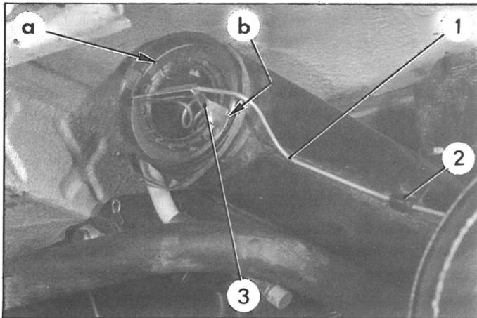
c) Accoupler le tube (1) au cylindre de roue arrière. Serrer l'écrou-raccord de **0,8 à 0,9 daNm** (garniture-joint neuve).
