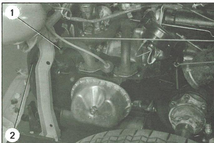
8. Poser le silencieux, sans serrer l'écrou de fixation de la patte, ni celui de la vis (3) de serrage du collier.
