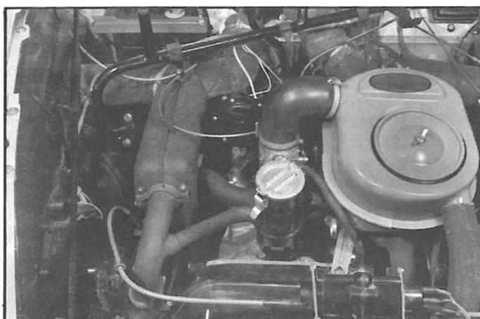
10. Dégager la cale placée sous la boîte de vitesses et descendre le moteur sur la traverse avant.
