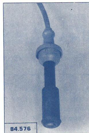
Les nouveaux fils de bougie avec prolongateur intégré assurent une isolation parfaite du circuit secondaire, en particulier au niveau des puits de bougie. Ils sont interchangeables avec les fils de l'ancien faisceau.
