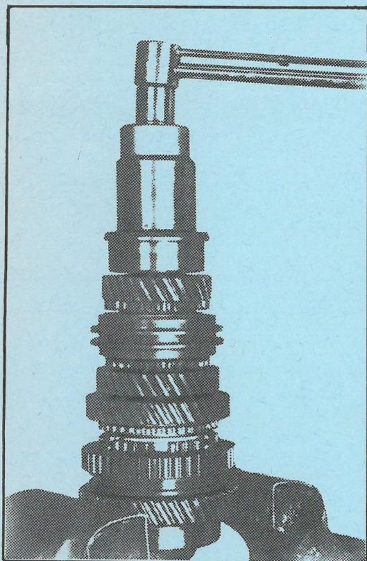
Løsne møtrikken (låst ved metaludkragning)
