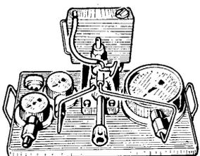
**3651-T** Banc d'essais, utilisé avec liquide hydraulique minéral L.H.M. **★ ★**
