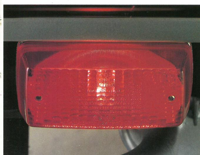
**Feu arrière de signalisation anti-brouillard**
