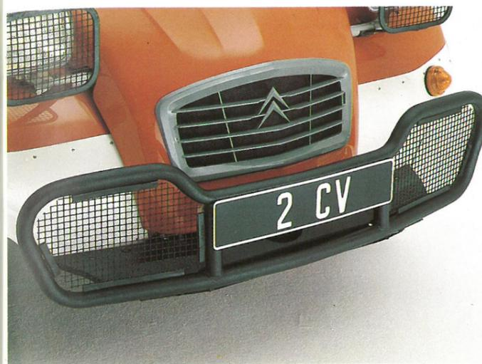
**Ensemble pare-chocs tubulaire AV avec tôle et grille**
