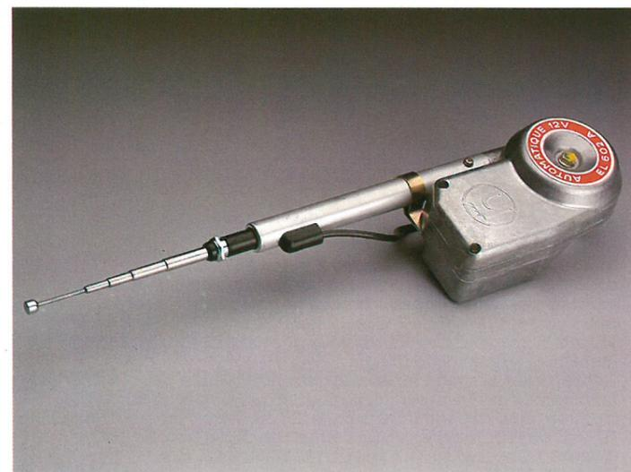
**Antenne électrique d'aile**
