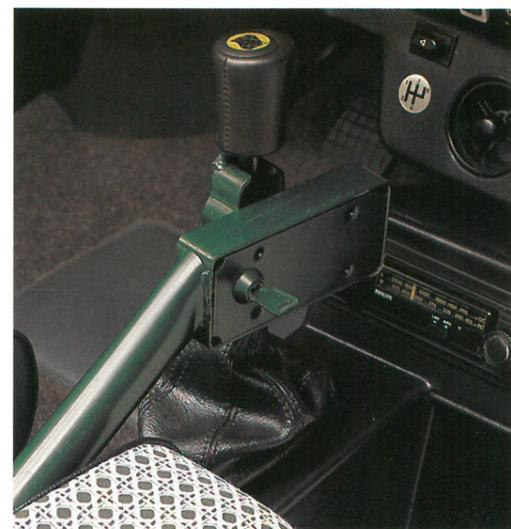
**Appareil de blocage sur frein à main et levier changement de vitesses**
