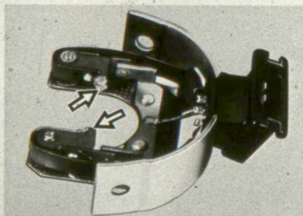
Vor dem Einbau eines neuen Einschubes sind die Ablenkstücke der Unterbrecherhebel mit Ft 1 v 4 leicht zu fetten.
