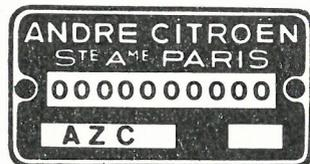
Plaque du n<sup>o</sup> moteur, rivée sur le bloc moteur à proximité du démarreur.
