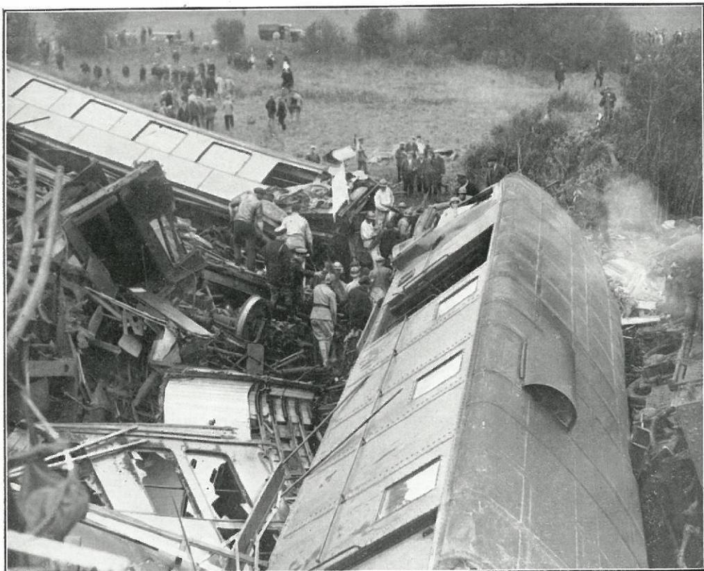
De cette récente collision entre wagons d'acier et wagons composites, les wagons d'acier sont sortis intacts ; les autres ne sont que débris.
