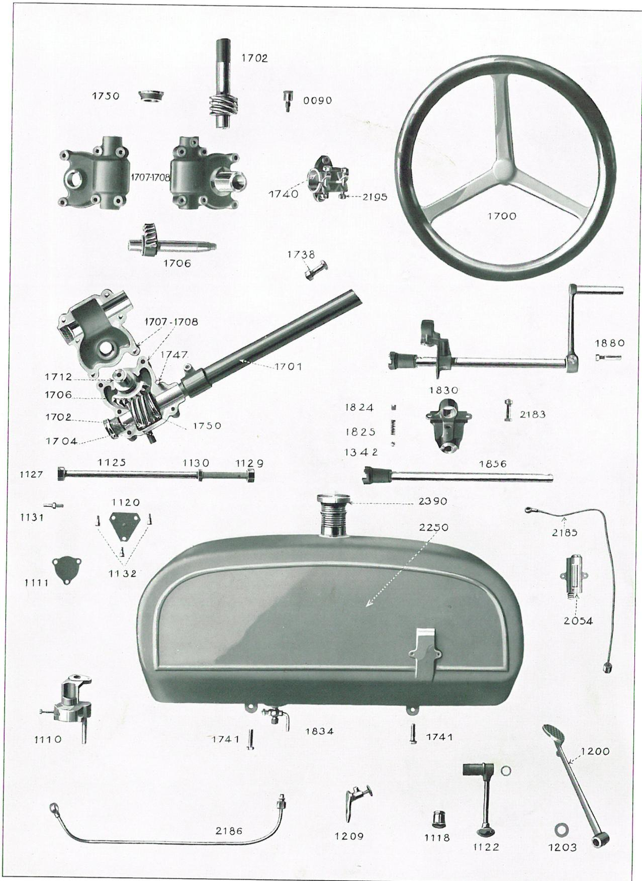
DIRECTION — MANIVELLE DE MISE EN MARCHÉ — GRAISSAGE — CARBURATEUR
