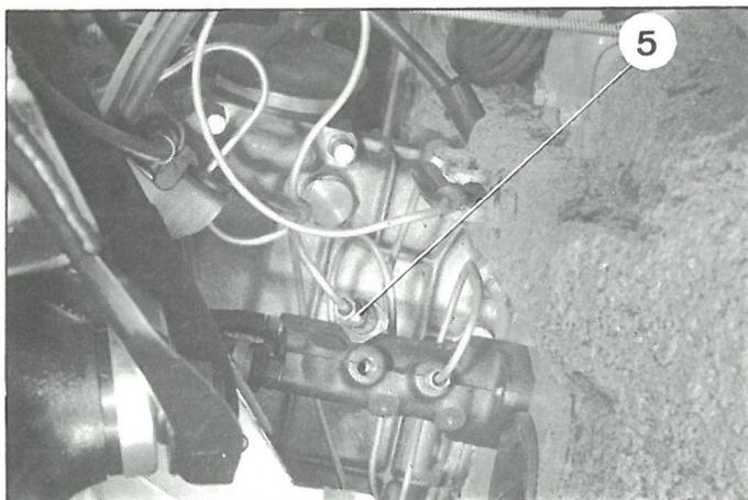
c) Vorderen, linken Federzylinder kontrollieren:
