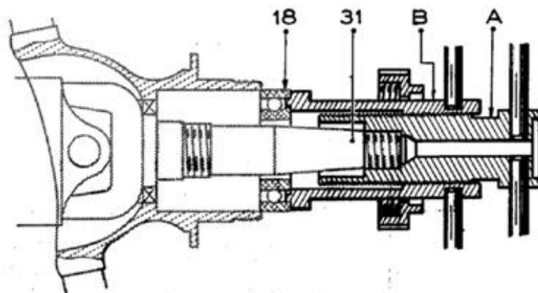
Fig. 1 - MISE EN PLACE DU ROULEMENT INTERIEUR DE FUSEE
