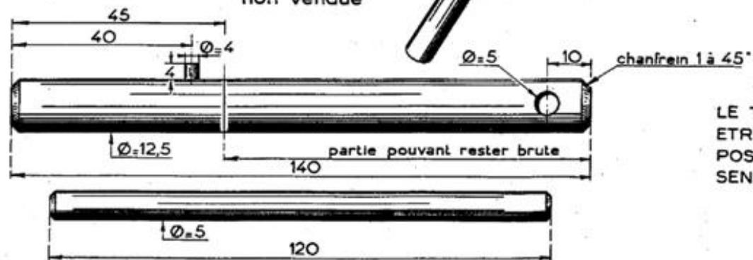
Fig. 2 - FREINAGE DES ECROUS DE BIELLE
