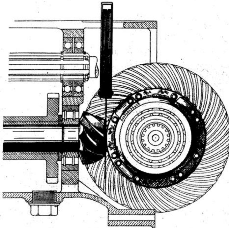
La circonférence extérieure du boîtier de différentiel centrante la couronne est rectifiée, son diamètre est de 110 mm. la distance conique est gravée sur la face du pignon d'attaque (voir Pl. 50)
