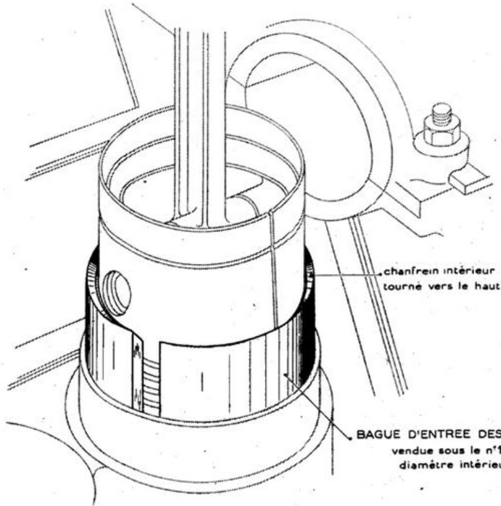
Fig. 2 - MISE AU ROND D'UN PALIER FONTE
