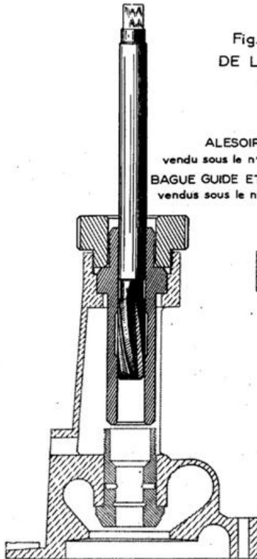
Fig. 2 - FRAISAGE SUR LA DOUILLE
