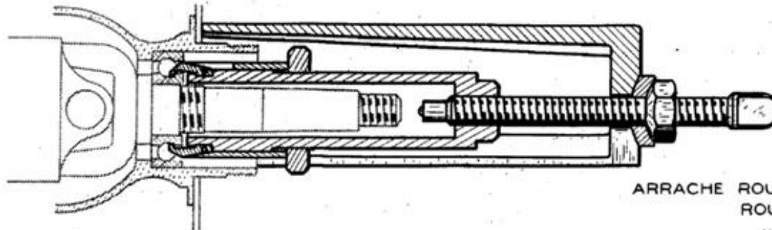
ARRACHE ROULEMENTS AVEC COUILLES POUR
