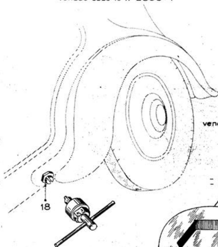
Fig.2 - CLE DE REGLAGE DE HAUTEUR AR
