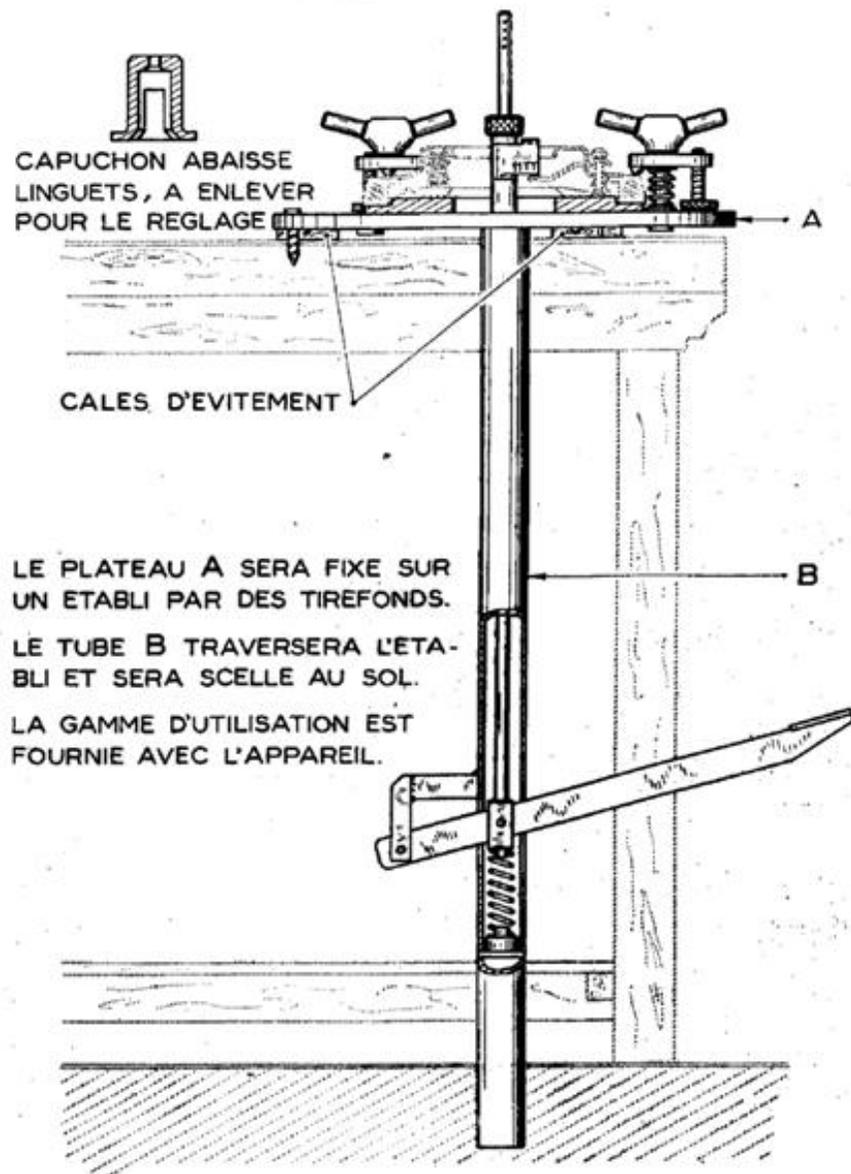
Fig 2\_ MECANISME EN POSITION «EMBRAYE»
