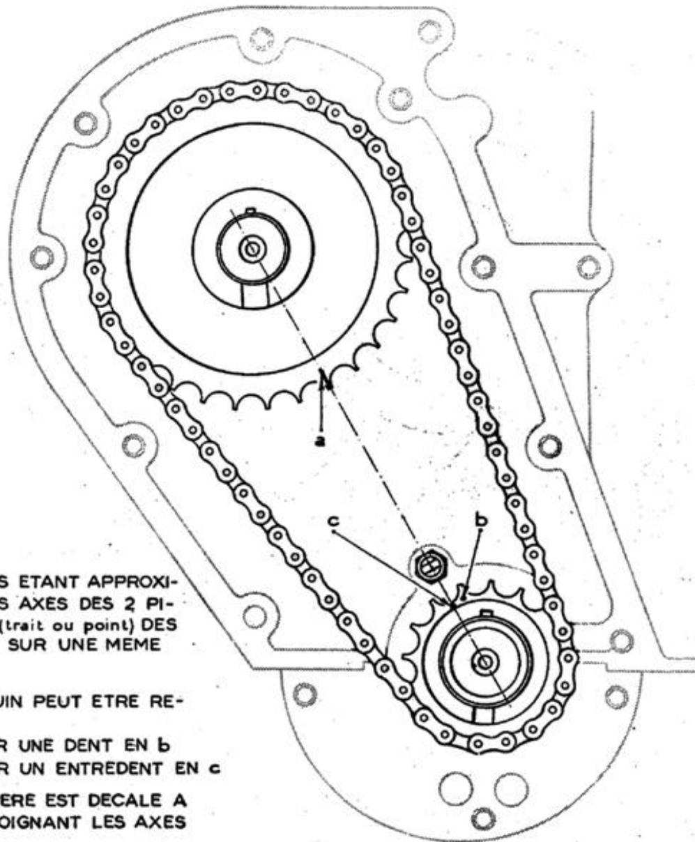
LES CYLINDRES EXTREMES ETANT APPROXIMATIVEMENT AU PMH, LES AXES DES 2 PIGNONS ET LES REPERES (trait ou point) DES PIGNONS DOIVENT ETRE SUR UNE MEME LIGNE DROITE
