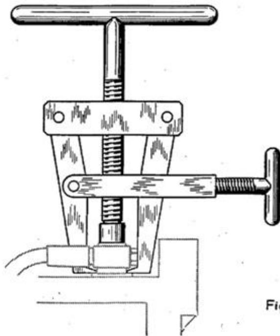
Fig. 4 \_ UTILISATION DU COMPRESSEUR
