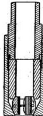
Fig. 5 \_ COMPRESSEUR DE RESSORTS
