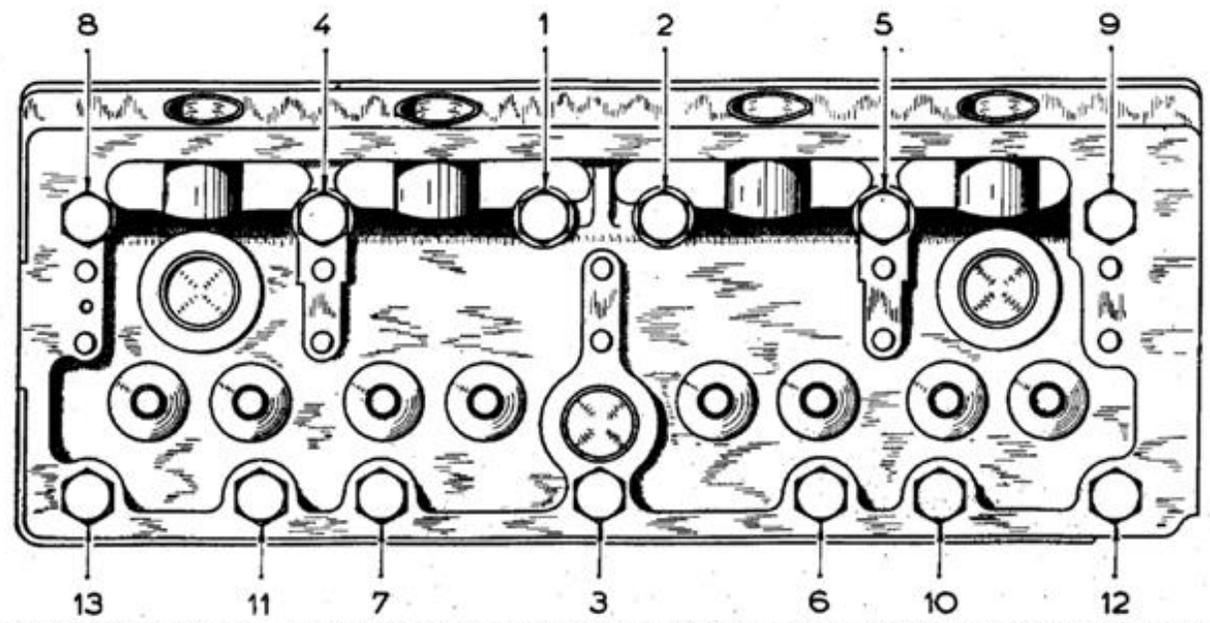
IL EST CONSEILLE DE SERRER LES ECROUS OU LES VIS DANS L'ORDRE INDIQUE CI-DESSUS; LES COUPLES DE SERRAGE DEVRONT ETRE RIGOREUSEMENT RESPECTES, POUR CELA IL EST INDISPENSABLE D'UTILISER UNE CLE DYNAMOMETRIQUE. CETTE CLE EST GRADUEE EN M.KG ET UTILISE DES EMBOUTS A CARRE DE 12,7 (vendus sous le n° 2465-T) QUAND L'EFFORT ATTEINT LE COUPLE DE SERRAGE INDIQUE AU VERNIER L'ARTICULATION A PLIE; ARRETER LE SERRAGE. L'ARTICULATION A NE DOIT JAMAIS VENIR EN BUTEE, EN B, SUR LE CORPS DE LA CLE.
