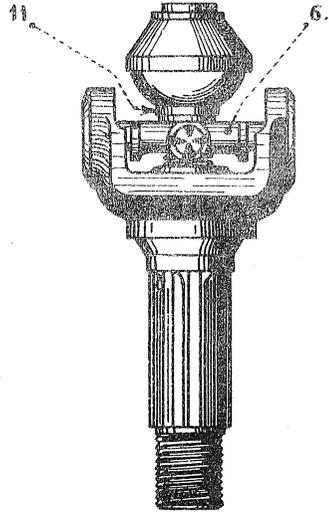
FIG. 6. EXTRACTING SPIGOT BALL AT STUB AXLE SIDE.
