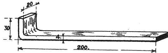
FIG.6. SPANNER FOR BEVEL PINION BEARING NUT.
