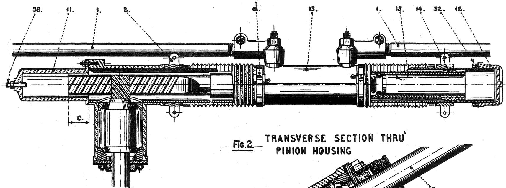
— Fig.2. — TRANSVERSE SECTION THRU PINION HOUSING
