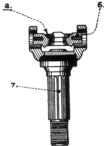
FIG.10. FITTING BALL-PIN.
