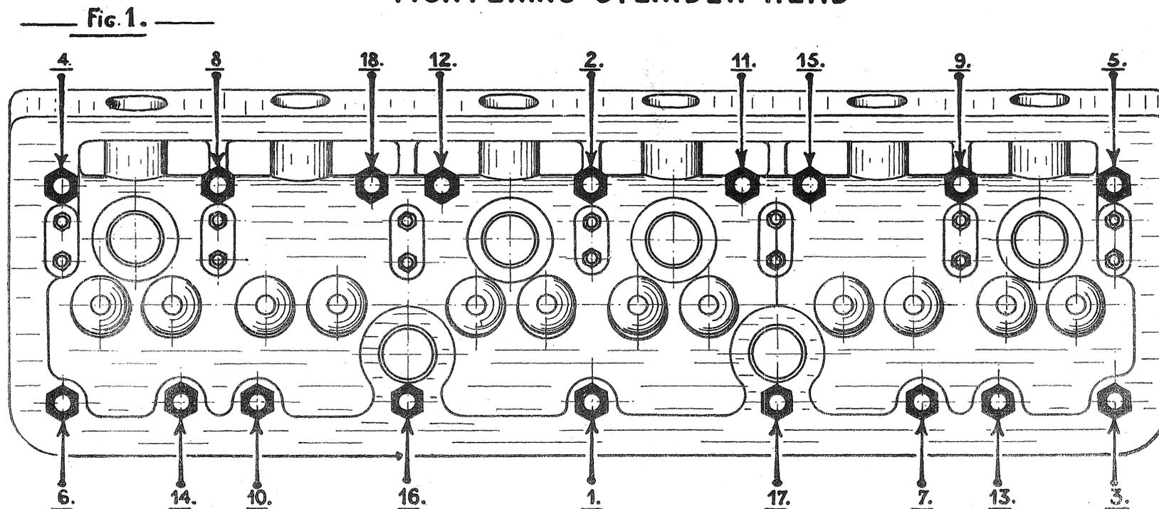
TIGHTNESS OF CYLINDER HEAD NUTS
