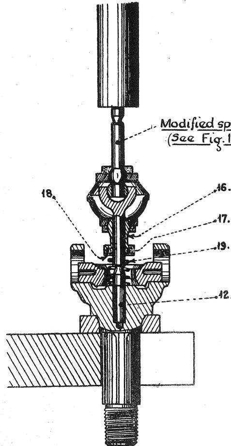
FIG.11. MODIFIED BALL SPINDLE.
