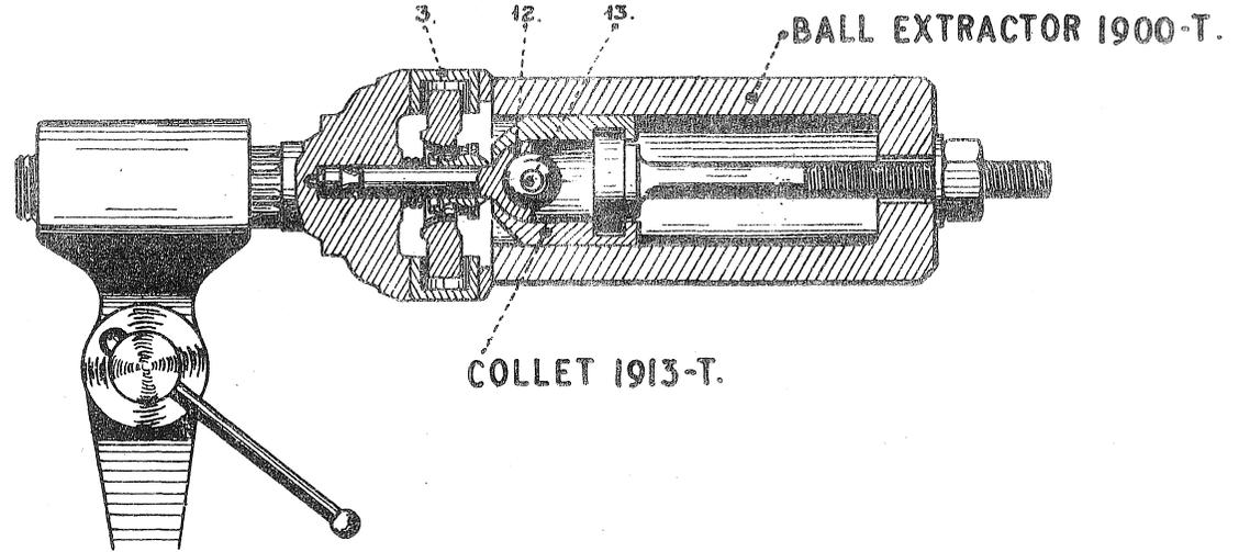
— Fig. 7. — EXTRACTING BALL SPINDLE.
