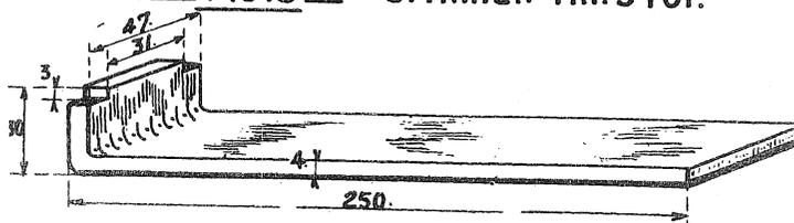
FIG.4. SPANNER 1780-T FOR SELECTOR FORK DISTANCE PIECE NUTS.
