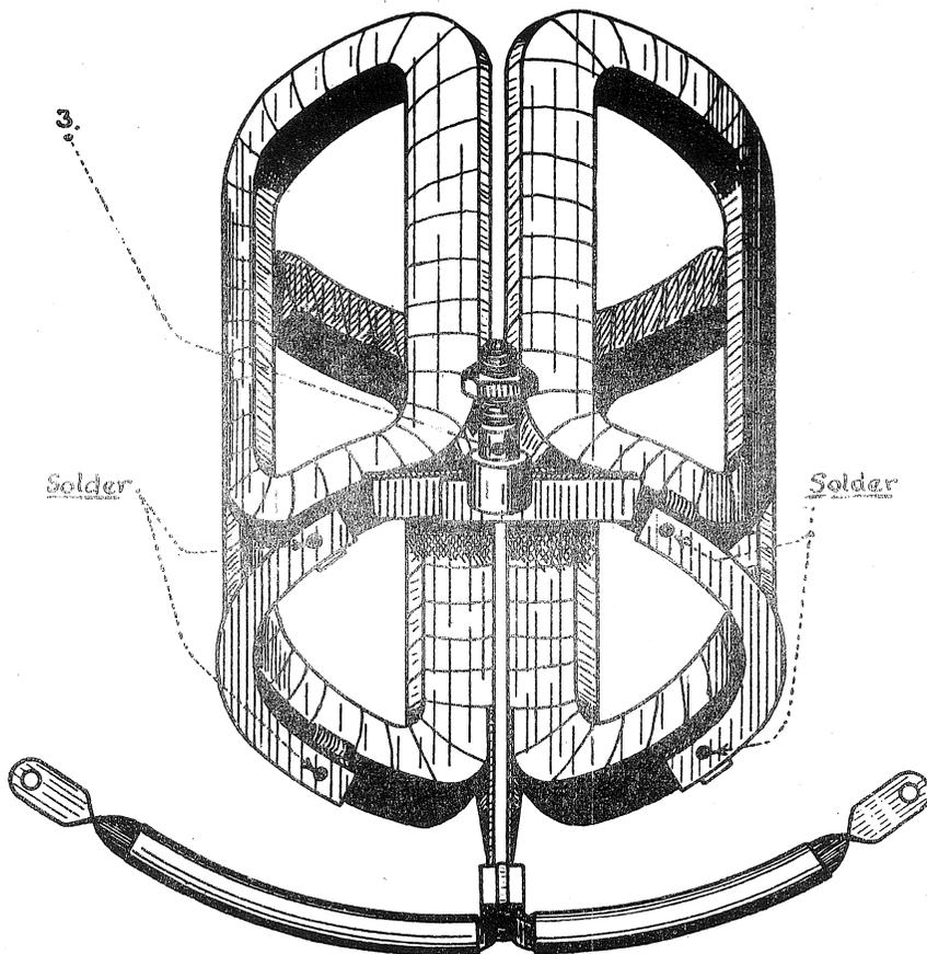
— Fig.2. — FITTING OF BRUSH GEAR
