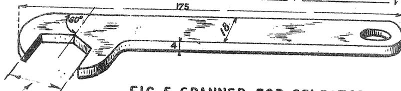
FIG.5. SPANNER FOR SELECTOR FORK DISTANCE PIECE.
