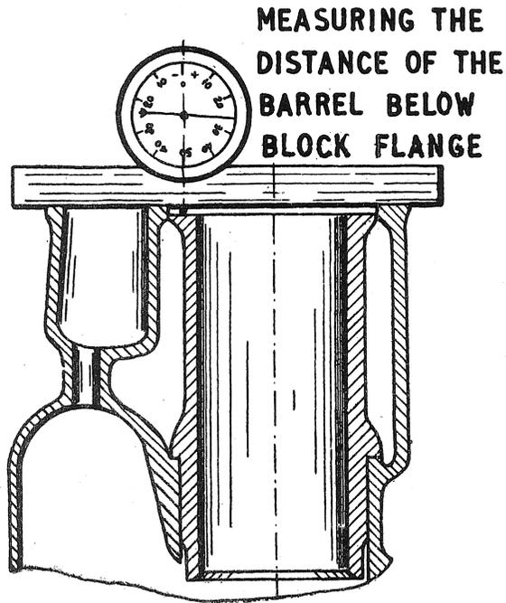
MEASURING THE AMOUNT THE BARREL STANDS PROUD OF BLOCK FLANGE AFTER FITTING LOWER JOINT
